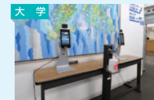
消毒液、検温カメラの設置
